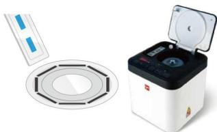
3. 将计数板插入到QUANTOM Tx™计数仪上进行计数。
