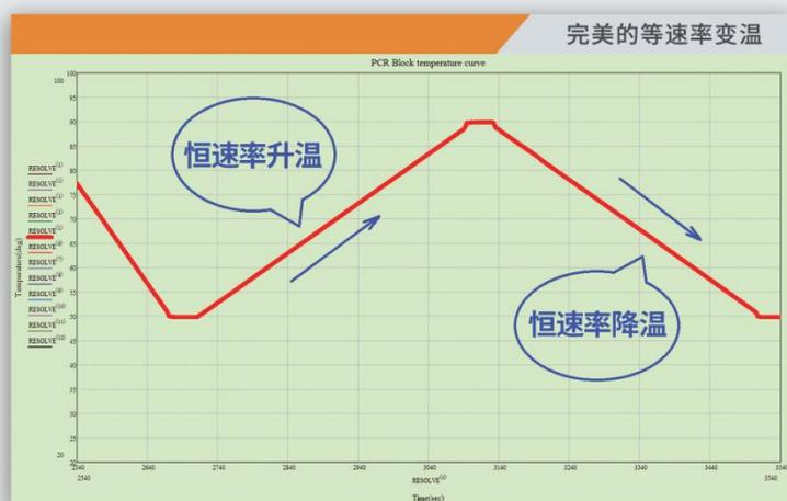
在实际应用中，并非所有的PCR实验都要求变温速率越快越好。有的检测试剂对PCR的升温或降温速率有一定的要求。尤其是有些临床试剂，如耳聋基因检测试剂盒，要求保持恒定的升温速率或降温速率，以确保PCR反应的结果。经过长期的技术积累和算法优化，ETC811Plus系列提供了近乎完美的线性控温曲线。
