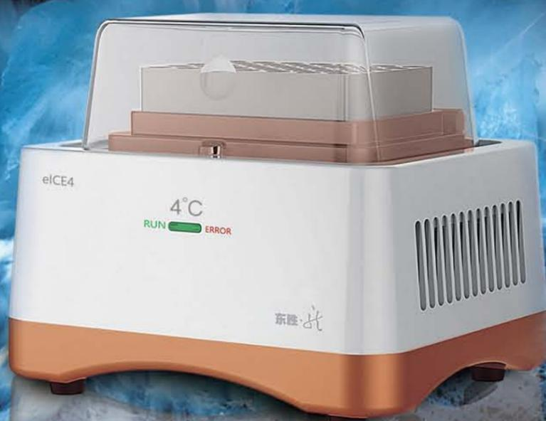
电子冰盒是分子生物实验室的必备仪器，也是PCR仪的伴随仪器。采用半导体制冷技术，开机后自动恒温在4°C，不用设定和调节。用于试剂的临时存放、试剂配置过程的存放、试剂配制工作台等，可更换模块以适应不同的试管，替代传统的制冰机、冰块、冰袋、冰盒等。干净卫生、方便快捷，省心放心。
